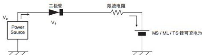
请将充电电压 $V_o$ 设定为不超过规定的上限值。
