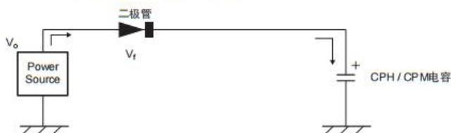
使用电容时没有充电电流的限制。因此不需要连接上电阻。
